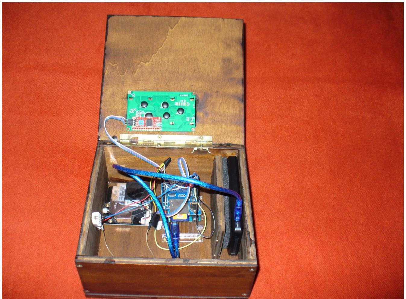
Das von der Stuttgarter Umweltgewerkschaft geliehene Gerät verwendet den gleichen Sensor, unterscheidet sich aber von dem Bauplan des OK Lab dadurch, dass es die Messwerte im Gerät selbst auf einer Speicherkarte speichert und auf einem kleinen Display anzeigt. Wir besprechen diese beiden Alternativen für den Bau von eigenen Geräten und geben eine Einführung in den Selbstbau.
