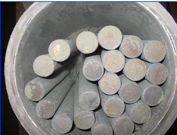
Mahlbehälter einer Schlagmühle mit Mahlstäben 7
