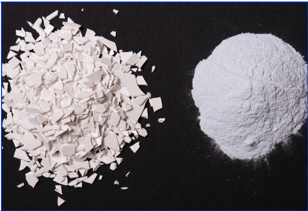
Partikel nach ungekühltem (links) , gekühltem Mahlen (rechts) 4
