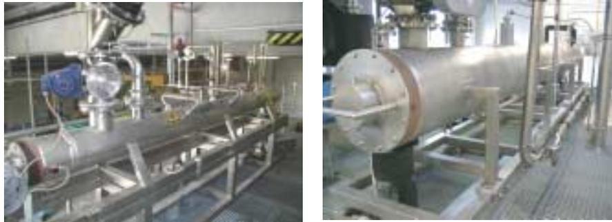
Abbildung 2: Cryo-Schnecke (links) und Feststoffkühler (rechts) für die Produktkühlung
