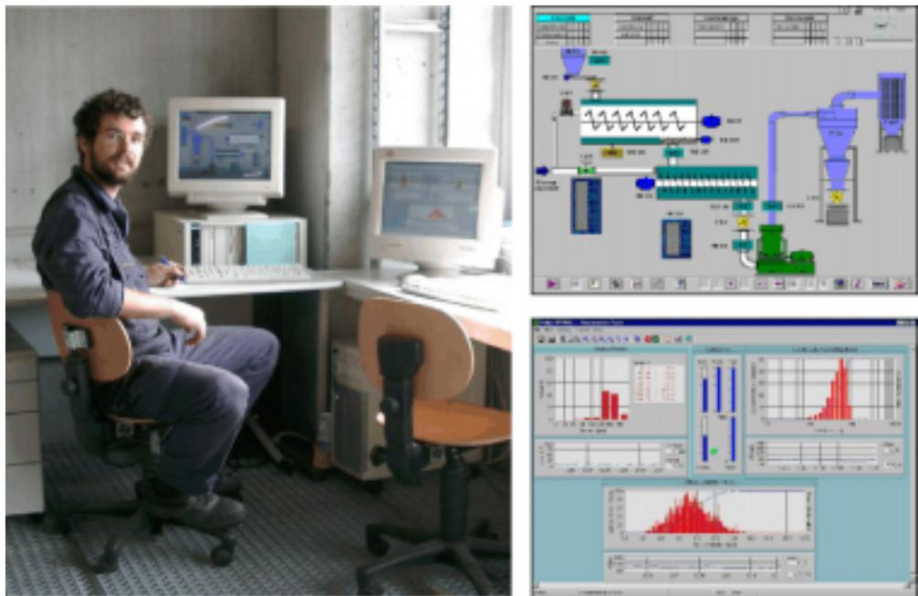
Abbildung 5: Anlagensteuerung mittels PC (links), Visualisierung Prozesssteuerung (rechts oben) und online Partikelgrößenmessung (rechts unten)
