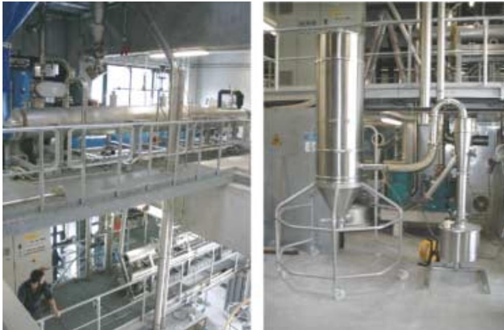
Abbildung 4: Kaltmahanlage mit Feststoffkühler; rechts: Beistellfilter und -zyklon
