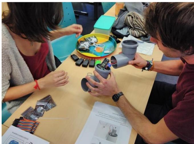
Unsere Messgeräte, die wir hier und heute verwenden haben denselben Sensor für Feinstaub und Temperatur/ Luftfeuchte. Sie sind aber mobil und benötigen kein WLAN bzw. Stromstecker. Sie haben eine Arduino-Plattform mit Mikrocontroller, ein SD-Card Shield um die Daten in einer CSV Datei zu speichern, sowie ein Display zur Anzeige der Messwerte.
